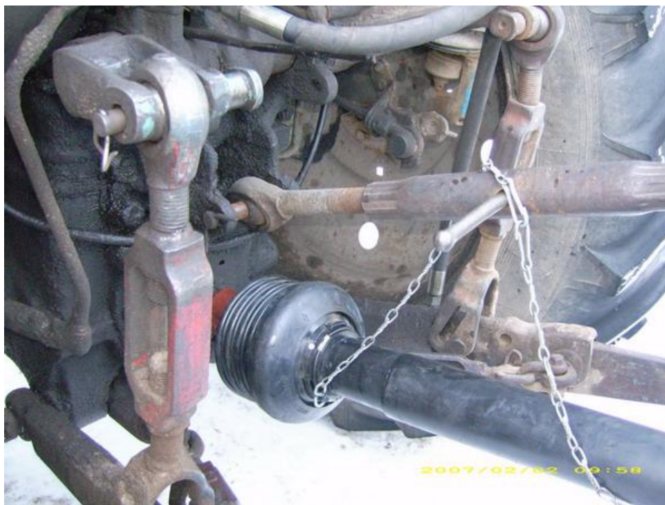
Рис. 3 – Схема крепления телескопического вала.
